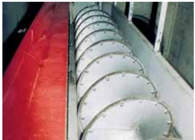
Tamiz HUBER ROTAMAT® RoK 1, tamaño 700, con sistema de medición de flujo
