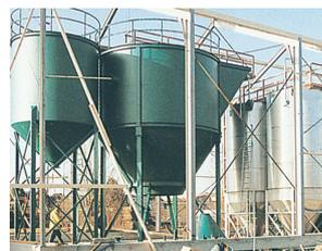
Instalación de una planta de tratamiento que consta de un decantador especial y de filtros SuperSand
