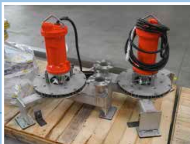
Aeratori con piedi speciali in gomma. Aerators with special rubber feet.
