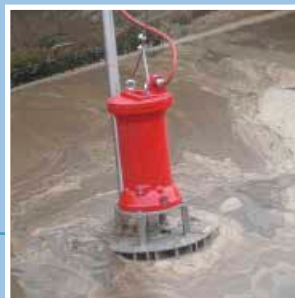
Fasi di immersione di aeratore sommerso tipo SC. Immersion stages of a submersible aerator type SC.
